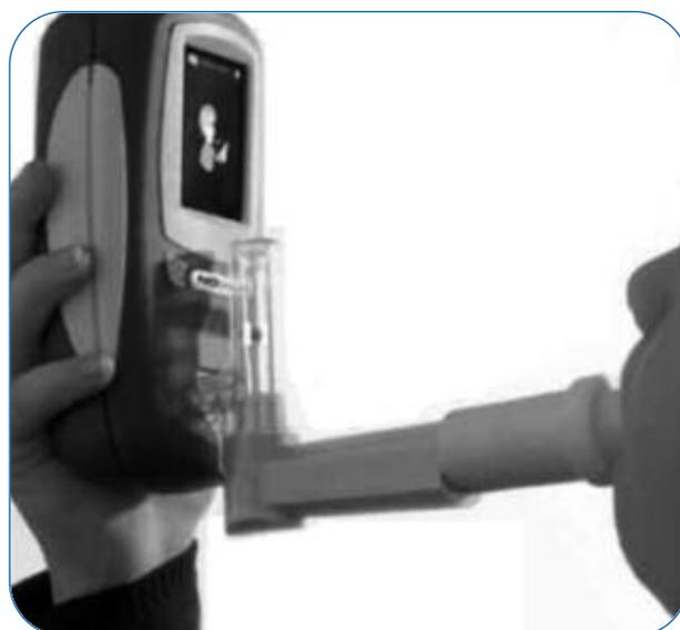
Figura 4 Esempio della misurazione del FeNO con tecnica "single breath" con la strumentazione COSMED® Quark NObreath.
